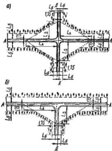
а - на пересечениях автомобильных дорог в одном уровне; б - на примыканиях автомобильных дорог в одном уровне;  $L_a$  и  $L_d$  - расстояние видимости поверхности дороги;  $L_b$  - расстояние боковой видимости; граница зоны видимости показана пунктиром
