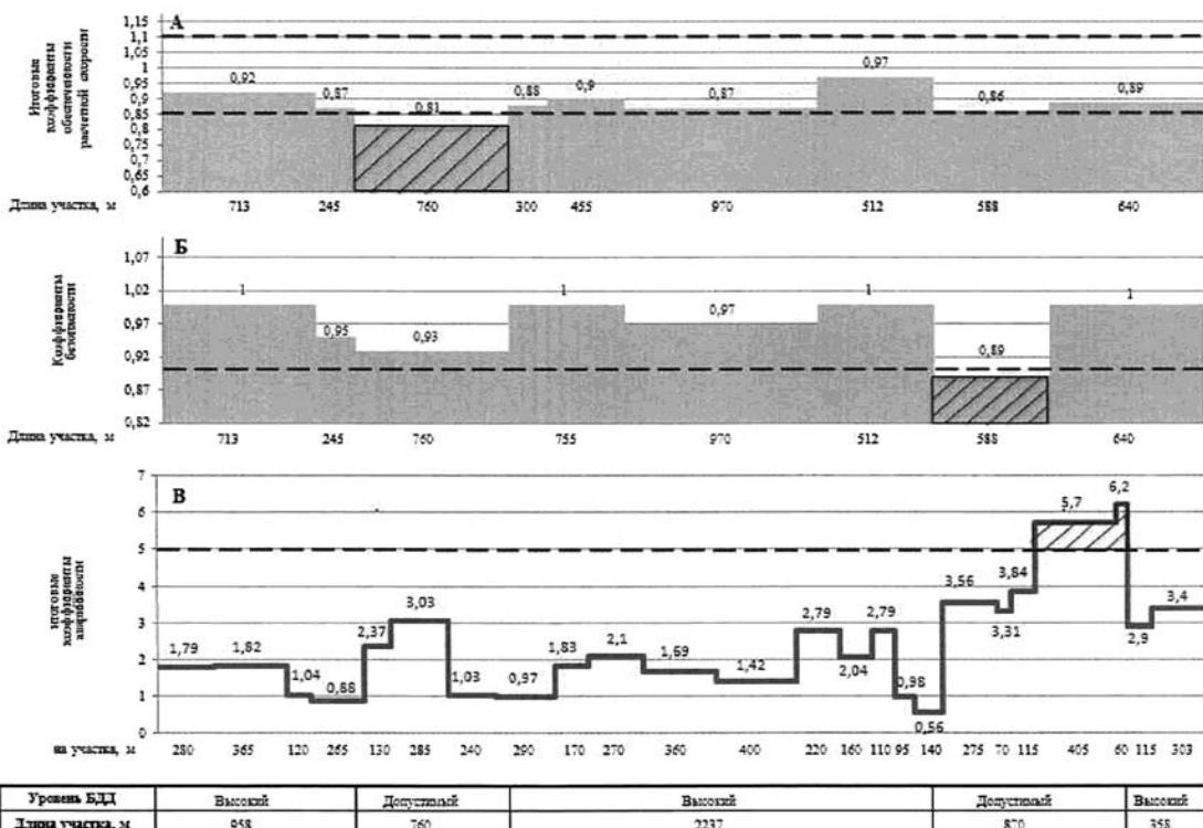
Линейные графики: А - итоговых коэффициентов обеспеченности расчетной скорости; Б - коэффициентов безопасности; В - итоговых коэффициентов аварийности
