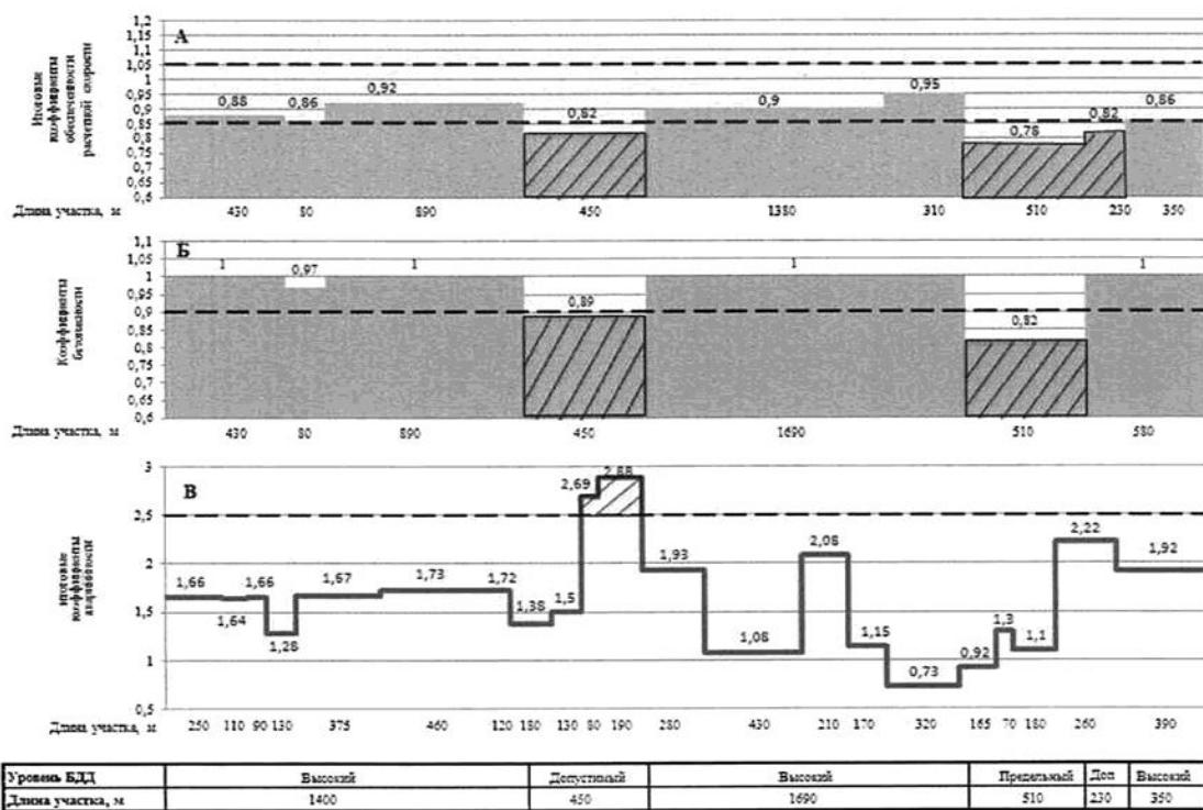
Линейные графики: А - итоговых коэффициентов обеспеченности расчетной скорости; Б - коэффициентов безопасности; В - итоговых коэффициентов аварийности
